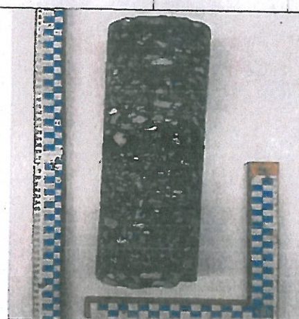
Carota 12; Ubicazione: S/N 43+500 centro; Spessore totale: 362 mm
