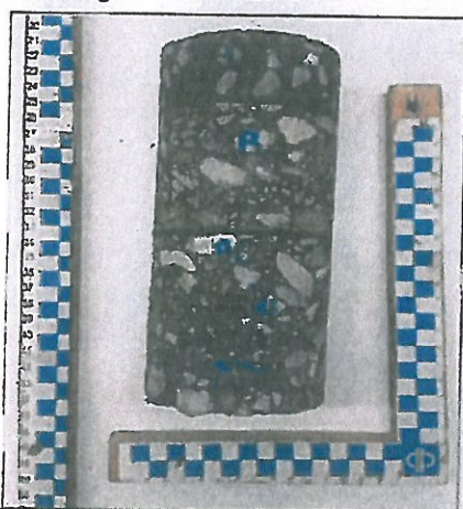
Carota 9; Ubicazione: S/N 40+200 normale - centro; Spessore totale: 197 mm
